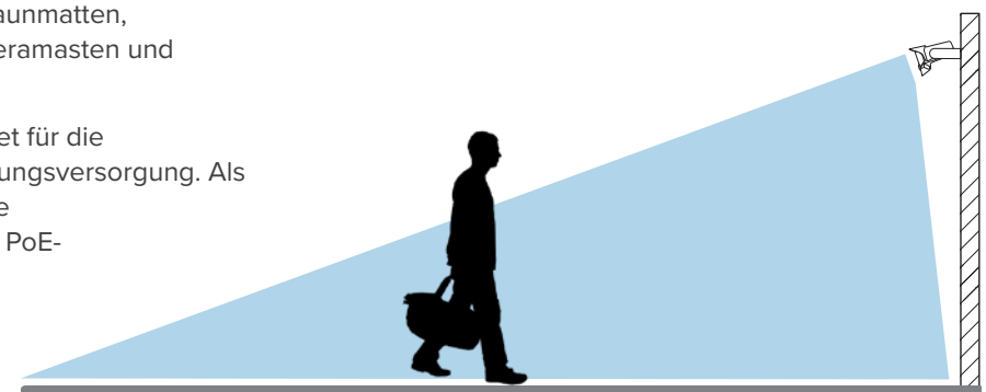
Senstar MultiSensor wird in einem Winkel von ca. 20° nach unten geneigt und zwischen 2,4 bis 3,7m über dem Boden installiert.
