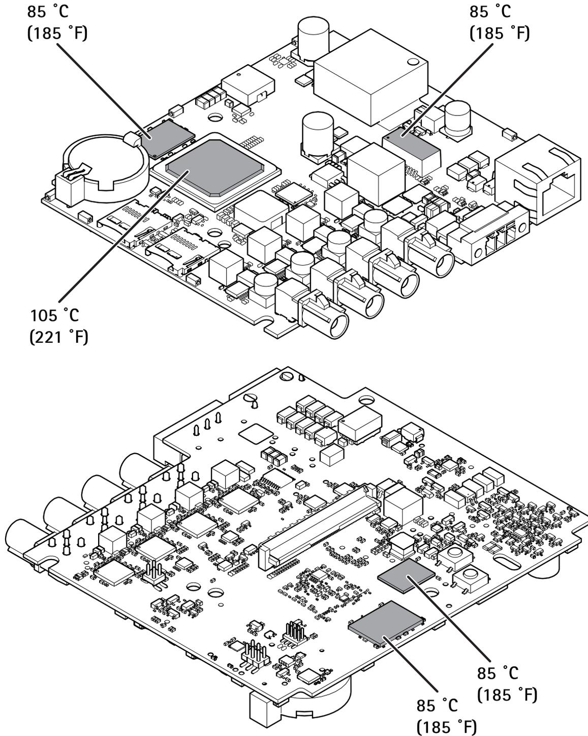
*Maximal zulässige Temperaturen. Wenn die Umgebungstemperatur 35 °C oder höher beträgt, steigt die Temperatur der Komponenten und sie müssen gekühlt werden.*
