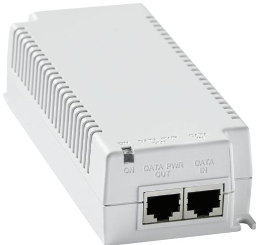
PoE Midspan ermöglicht den Betrieb verschiedener Bosch IP-PTZ-Kameras mittels einer abgesetzten PoE-Stromversorgung. PoE Midspan stellt maximal 60 W bereit und entspricht der Norm IEEE 802.3bt. Das PoE-Midspan hat einen Port und liefert Strom über alle 4 Paare.
