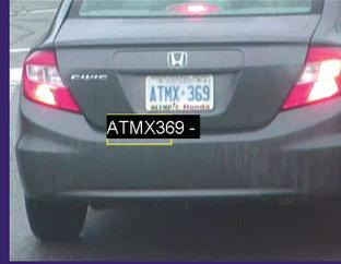
Erfasst automatisch Kfz-Kennzeichen von Fahrzeugen aus über 100 Ländern. Es können Alarme für bestimmte Kennzeichen ausgelöst werden, bzw. die Zufahrt zum Gelände automatisch erlaubt oder verweigert werden.
