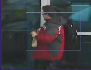
Auto PTZ steuert PTZ-Kameras automatisch und in Echtzeit. Personen und Fahrzeuge im Sichtfeld der Kamera können selbstständig vom System verfolgt und herangezogen werden. Auto PTZ ist ideal für die Perimeterüberwachung im Außenbereich geeignet und liefert mehr Details von Personen und Fahrzeugen für die spätere forensische Nachbetrachtung.
