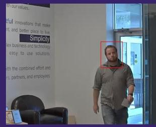
Eine robuste Videoanalyse, die sich ideal für die Zugangskontrolle in Einrichtungen mit hohen Sicherheitsansprüchen eignet. Durch Alarmierung in Echtzeit, intuitive Suchfunktionen und die Verknüpfung zu Aimetis Symphony, bringt die Gesichtserkennung Ihr Videoüberwachungssystem auf eine neue Ebene.
