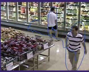
Erkennt und verfolgt alle Personen im Blickfeld der Kamera. Alarme können ausgelöst werden, wenn Personen bestimmte Bereiche unbefugt betreten. Verweilzeiten werden erfasst und aufgezeichnet, um ungewünschtes Herumlungern zu melden. Mit Heat Maps lassen sich gerade im Einzelhandel Bereiche ausfindig machen, die stark frequentiert sind oder in denen Kunden besonderes Interesse zeigen.
